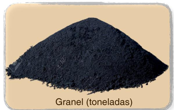
**Las MEZCLAS BITUMINOSAS PERDURABLES se fabrican en caliente con la tecnología convencional y pueden ser acopiadas durante varios meses a temperatura ambiente, consiguiendo cubrir las necesidades de los trabajos de pavimentación en obras de canalización y/o bacheos.**
