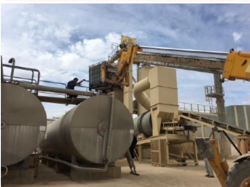
La mezcla se fabrica en caliente con betunes de penetración y se almacena a temperatura ambiente durante largos periodos de tiempo sin perder sus propiedades.
